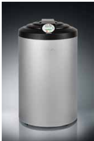
Obr. 5. Jednoduché cenově dostupné univerzální tepelné čerpadlo země/voda, voda/voda FACTOR plus s vysokým topným faktorem. Při teplotním spádu W10/W25 °C dosahuje tepelné čerpadlo o 40 % vyšší topný faktor než u systému s podlahovým vytápěním (W10/W35 °C); až o 120 % vyšší ve srovnání s otopnými tělesy (W10/W50 °C)
